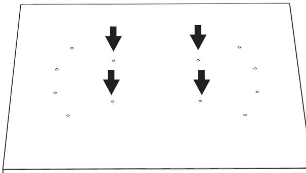
ALINEAR EL ORIFICIO METÁLICO DEL SET DE PATAS CON UNA DE LAS 4 CAVIDADES DEL TABLERO
