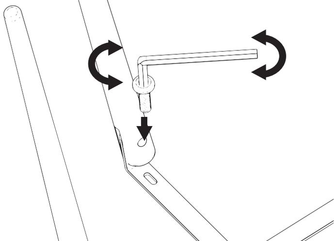
AJUSTAR HASTA EL FONDO Y REPETIR EL PROCESO CON EL RESTO DE 3 ORIFICIOS
