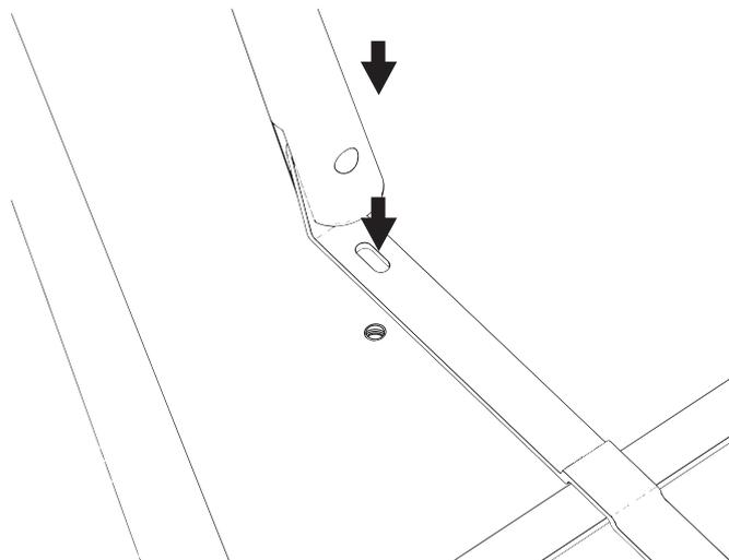
COLOCAR EL TORNILLO EN LA CAVIDAD Y AJUSTAR CON LA LLAVE ALLEN (L) EN SENTIDO DE MANECILLAS DEL RELOJ
